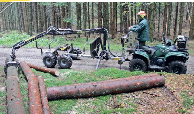
Im Einsatz: Der Rückewagen VAHVA JUSSI 400 in Kombination mit Ladekran ist ein professionelles Arbeitsgerät.
