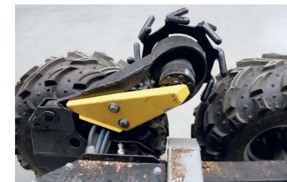
Einfach genial: Per Hydraulik senkt der gelbe Ausleger den sich drehenden Stahlkorb auf die Räder, die dadurch in Bewegung gesetzt werden.
