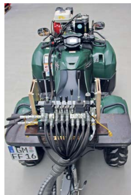
Hebelwerk: Die hydraulische Steuereinheit für den Hebekran ist imposant.
