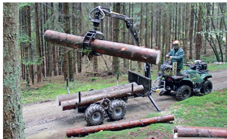
Kann zupacken: Der bis 75 cm weit öffnende Greifer ist für große Aufgaben gerüstet.
